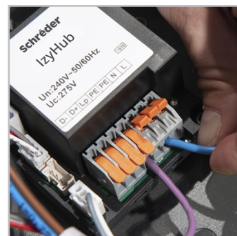
Il modulo IzyHub a prova di guasto facilita il collegamento elettrico durante l'installazione e durante le operazioni di manutenzione.
